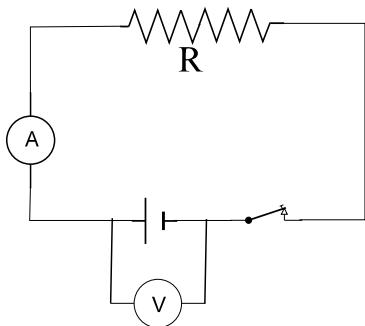
Με κλειστό το διακόπτη η ένδειξη του βολτόμετρου είναι 60V και του αμπερόμετρου 5A.
