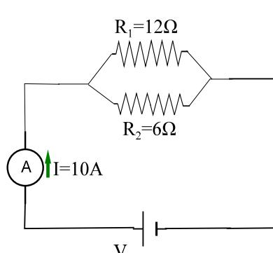
Οι δύο αντιστάτες  $R_1=12\Omega$  και  $R_2=6\Omega$  συνδέονται παράλληλα και τροφοδοτούνται με τάση  $V$ . Η ένδειξη του αμπερόμετρου είναι  $I=10A$ . Υπολογίστε:
