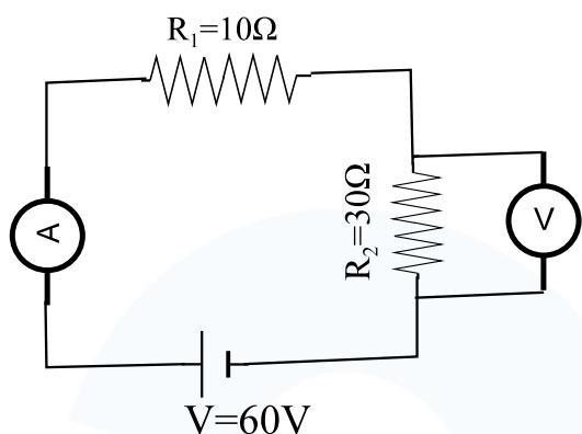
6. Στο κύκλωμα της εικόνας δίνονται: Η τάση της πηγής  $V=60V$  και οι αντιστάσεις  $R_1=10\Omega$  και  $R_2=30\Omega$ . Βρέστε τις ενδείξεις των δύο οργάνων μέτρησης.
