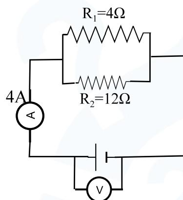
7. Η ένδειξη του αμπερόμετρου είναι  $4A$  και οι αντιστάσεις είναι  $R_1=4\Omega$  και  $R_2=12\Omega$ .
